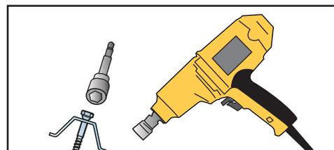
7 Visser les deux vis fournies avec le connecteur à l'aide une boullonneuse à chocs.
