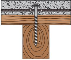
Connecteur type "OMEGA", plaque de base 38x30x90 mm,
