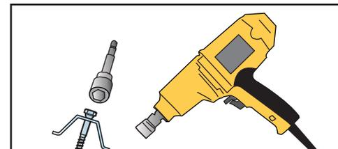
7 Visser les deux vis fournies avec le connecteur à l'aide d'une boulloneuse à chocs.
