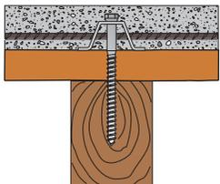
Connecteur type "OMEGA", plaque de base 38x30x90 mm,
