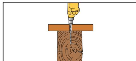
4 Percer un pré-trou de Ø 8 mm sur une profondeur égale à la longueur de la vis.
