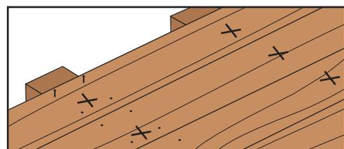
2 Indiquer les distances auxquelles doivent être positionnés les connecteurs.
