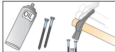
5 Lubrifier les vis et insérer les dans les trous de la plaque du connecteur par un coup de marteau sec.
