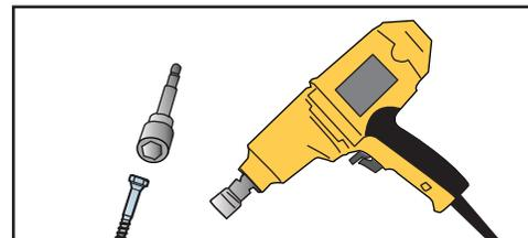
8 Visser les deux vis fournies avec le connecteur à l'aide d'une boullonneuse à chocs. Si les crampons ne rentrent pas dans le bois par le vissage, marteler les angles de la plaque de base pour en faciliter la pénétration.
