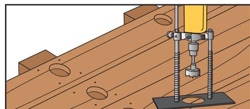
3 Percer les trous avec une fraise circulaire ou une scie cloche de Ø 65 mm
