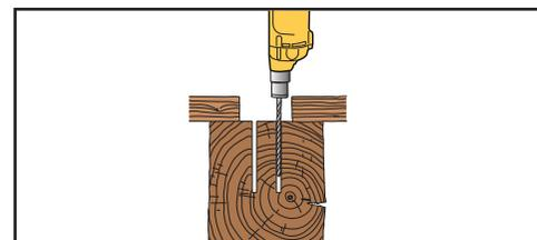
5 En cas de bois dur, percer un pré-trou de Ø 5 ou 6 mm sur une profondeur égale à la longueur de la vis.
