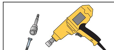
8 Visser les deux vis fournies avec le connecteur à l'aide d'une boulonneuse à chocs. Si les crampons ne rentrent pas dans le bois par le vissage, marteler les angles de la plaque de base pour en faciliter la pénétration.
