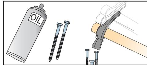
6 Lubrifier les vis et insérer les dans les trous de la plaque du connecteur par un coup de marteau sec.
