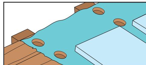
4 Étaler un film de protection imperméable (transpirant de préférence) et le découper au niveau des trous préalablement percés.
