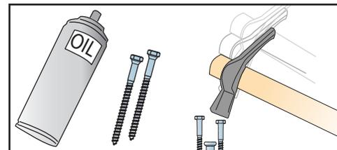
6 Lubrifier les vis et insérer les au niveau des trous de la plaque du connecteur par un coup de marteau sec.
