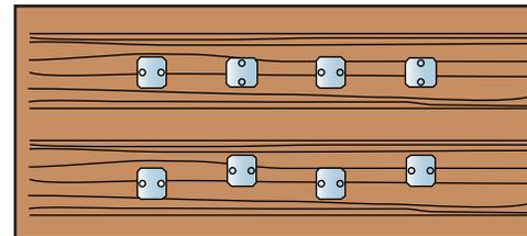
7 Placer les connecteurs en décalage les uns par rapport aux autres, si la largeur du support le permet.
