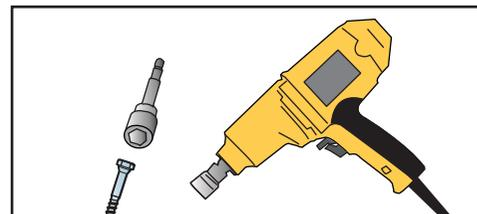
7 Visser les deux vis fournies avec le connecteur à l'aide une boulloneuse à chocs. Si les crampons ne rentrent pas dans le bois par le vissage, marteler les angles de la plaque de base pour en faciliter la pénétration.
