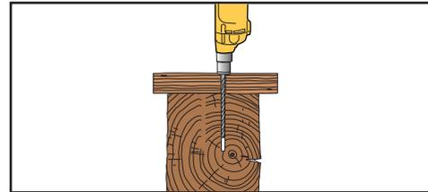
4 En cas de bois dur, percer un pré-trou de Ø 5 ou 6 mm sur une profondeur égale à la longueur de la vis.
