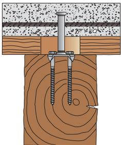
Connecteur type "BASE", plaque de base 50 x 50 mm, vis Ø 8 mm
