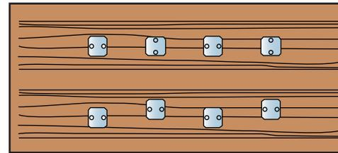
6 Placer les connecteurs en décalage les uns par rapport aux autres, si la largeur du support le permet.
