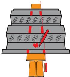
É importante localizar a posição exata da viga sob o pavimento antes de realizar a fixação. Sugerimos que uma linha seja rastreada. Cada ligador deve ser fixo com quatro pregos. O ligador deve sempre ser fixo transversalmente ao eixo da viga quando fixo sobre uma laje de betão. (Ver fig.A)
