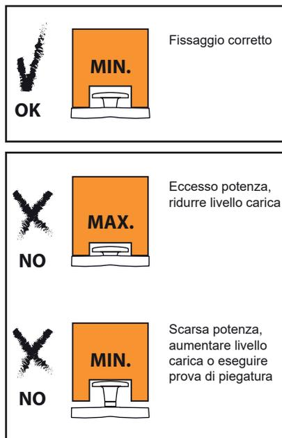
Valori inferiori ai 3,5 mm (MAX): non compromettono la tenuta del connettore; sarebbe però opportuno abbassare il livello di potenza del propulsore, al fine di evitare rotture nella chiodatrice dovute a sovra-potenza.
