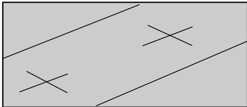
2 Los conectores se deben fijar en las viguetas. Marcar las posiciones donde fijar los conectores.
