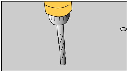
3 Hacer un orificio con una taladradora con una punta de 8 mm y una profundidad de 70 mm. Si el orificio no se puede utilizar (debido a la presencia de barras de acero), perfora un nuevo orificio a una distancia del doble de la profundidad del orificio que no se puede utilizar.
