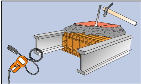
1 Eliminar las pavimentaciones existentes y descubrir el trasdós de las viguetas de hormigón. En caso de forjado con alcatifa identificar las viguetas mediante sondeos específicos.
