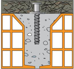
Conector MINI CEM-E de tornillo - cuerpo Ø 10 mm, tornillo Ø 10 mm, arandela móvil de acero Ø 30 mm, espesor 2.7 mm
