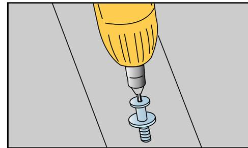
5 Introducir el tornillo en el orificio y enroscarlo con un destornillador eléctrico de impulso. Par de apriete mínimo 50 Nm. Tener cuidado de no seguir enroscando una vez que la placa y el tornillo hagan contacto.
