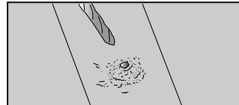
4 Quitar el polvo de cemento soplando o aspirando en el interior del orificio. Rechace la superficie si así lo prescribe el diseñador. Limpiar a fondo la superficie de escombros y arena.
