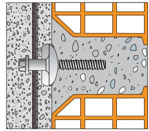
Conector CT CEM-E de tornillo y placa dentada
