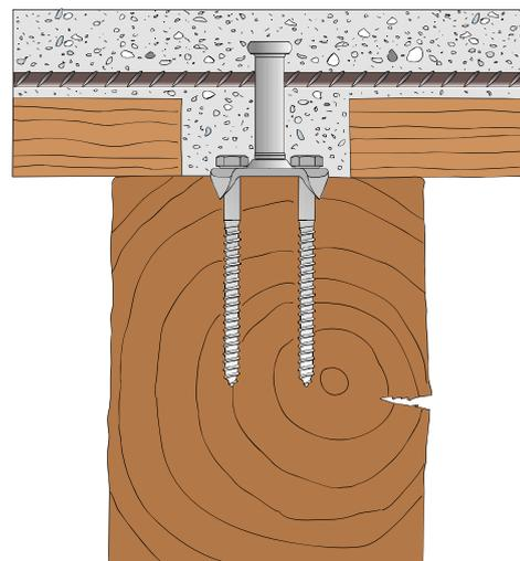
Connecteur fourni avec deux vis tirefond 8 X 100 mm (ou 8 X 70 mm) DIN571
