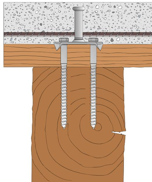
Connecteur fourni avec deux vis tirefond 10 X 120 mm (ou 10 X 100 mm) DIN571
