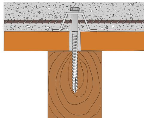
Connecteur composé de 1 vis tire-fond 10x100, 120 et 140 mm et de 1 plaque stabilisatrice.
