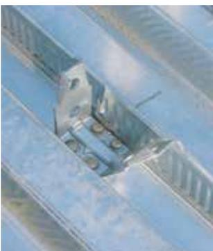
O ligador DIAPASON é feito de uma placa galvanizada de 3mm de espessura, moldada para obter uma base de modo a ser fixa com quatro pregos à viga de aço e duas asas para criar uma ligação mais eficiente com o betão. Este ligador fornece uma alta performance mecânica.
