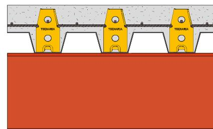
Il connettore DIAPASON si utilizza tutte le volte che risulta necessario fissare 2 connettori CTF affiancati.
