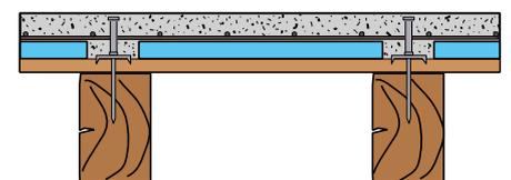
L'interposizione di un pannello di materiale isolante rigido permette di aumentare la sezione della trave mista legno-calcestruzzo senza incrementare il peso proprio del solaio, **migliorando il rinforzo**. Si ottengono vantaggi in termini di resistenza, rigidità, numero di connettori ed isolamento termo-acustico.
