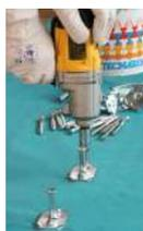
Avvitatore elettrico a impulsi; per le sue caratteristiche ideale a fissare le viti dei connettori nel legno, attacco quadro da 1/2".
