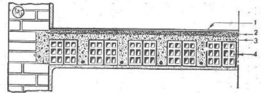
Fig. 42 — SOLAIO IN CEMENTO ARMATO E MATTONI FORATI COMUNI. - 1 Pavimento - 2 Sottofondo - 3 Gellata in calcestruzzo di cemento - 4 Mattoni forati.
