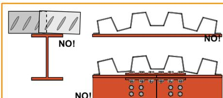
NON si possono fissare i connettori con sovrapposizioni irregolari di più fogli di lamiera, sopra lamiere che non siano bene aderenti alla trave o sopra travi imbullonate.
