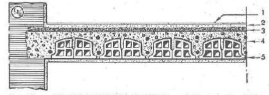
Fig. 43 — SOLAIO "MIOZZO SALERNI". - 1 Pavimento - 2 Lastre isolanti - 3 Sottofondo - 4 Gellata in calcestruzzo di cemento - 5 Foraloni in laterizio.
