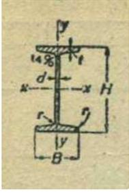
Nel passato non si usavano profili a geometria uniformata. E' quindi necessario rilevare la sezione del profilo ed individuare le caratteristiche dell'acciaio. Normalmente si utilizzavano profili tipo IPN o NP. A causa della loro composizione chimica le travi esistenti spesso non sono saldabili.
