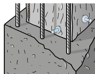
Le barre verticali andranno inghisate alle fondazioni con le resine bicomponenti Tecnar, in appositi fori creati al piede del pilastro.
