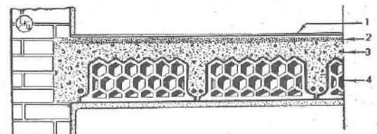
Fig. 44 — SOLAIO "ADAMOLI". - 1 Pavimento - 2 Sottofondo - 3 Gellata in calcestruzzo di cemento - 4 Foraloni ad alveare.
