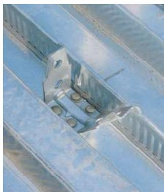
Il connettore DIAPASON è realizzato in lamiera zincata di spessore 3 mm, sagomata in modo da ottenere una base fissata con **quattro chiodi** alla trave in acciaio e due ali superiori per un più efficace collegamento con il calcestruzzo. Questo connettore è caratterizzato da elevate prestazioni meccaniche.
