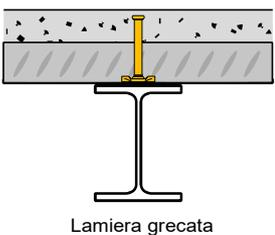
Nei casi in cui il connettore è posato in una gola di una lamiera grecata trasversale alla trave, la resistenza del connettore dipende dalla classe del calcestruzzo, dalla geometria delle onde e dall'altezza del connettore. La resistenza è calcolata come prodotto di un fattore riduttivo K<sub>t</sub> e di una resistenza di riferimento P<sub>0</sub>.
