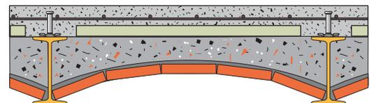
L'interposizione di un pannello di materiale isolante rigido permette di aumentare la sezione della trave mista acciaio-calcestruzzo senza incrementare il peso proprio del solaio. Si ottengono vantaggi in termini di resistenza, rigidità ed in parte di isolamento termo-acustico.
