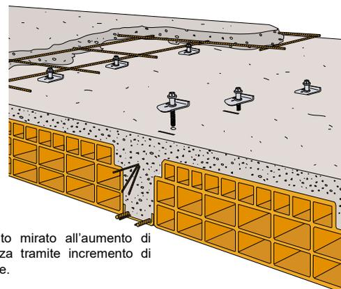
Intervento mirato all'aumento di resistenza tramite incremento di spessore.
