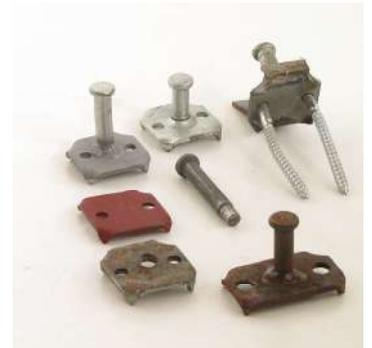
Estudios y prototipos de los conectores para forjados de madera CTL BASE (1994) y CTL MAXI (2002).
