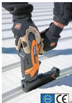
La clavadora Spit P560, equipada con el kit "cargador" (código 013952), también puede utilizarse para clavar chapas en vigas de acero, tanto en el caso de forjados como de revestimientos verticales.
