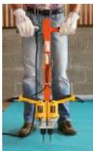
Dos taladros eléctricos montados en un bastidor ergonómico permiten hacer dos orificios al mismo tiempo a la distancia correcta en la madera para introducir los tornillos del conector MAXI.
