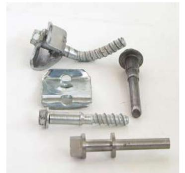
2002: prototipos del conector CTCEM para forjados de ladrillo-cemento.
