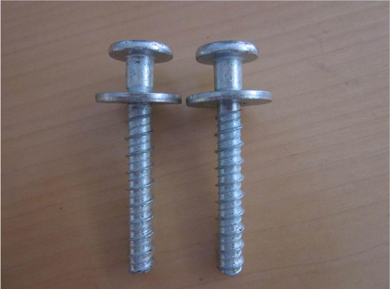
Il connettore è costituito da una vite con filetto per calcestruzzo. La vite è in acciaio al carbonio C21 con trattamento di cementazione per indurire il filetto e far in modo che possa filettare il calcestruzzo senza rovinarsi.
