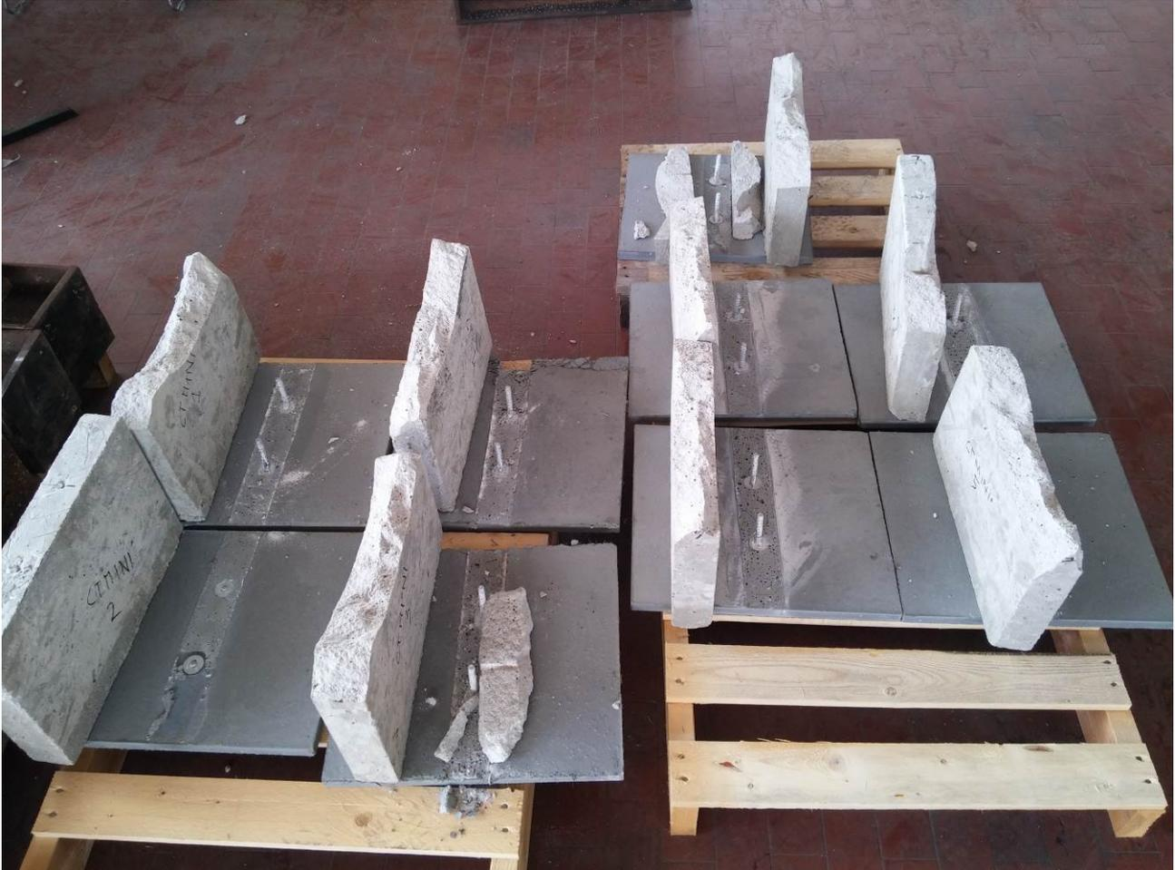
Su 9 campioni provati, 7 hanno avuto rottura sul travetto in calcestruzzo, 1 ha avuto rottura delle due viti e 1 ha avuto una rottura mista (1 vite rotta e una parte di travetto rotta).
