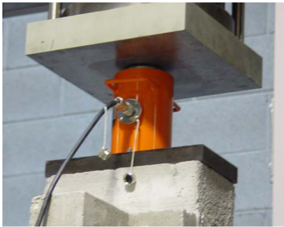
Fig. 7. Cella di carico per la misura della azione verticale applicata.
