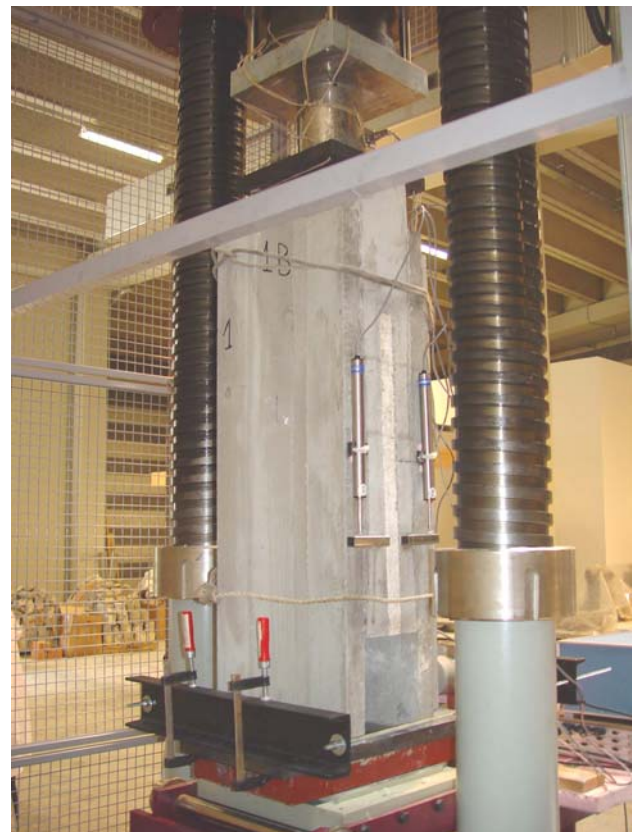
Fig. 5. Disposizione degli strumenti di misura
