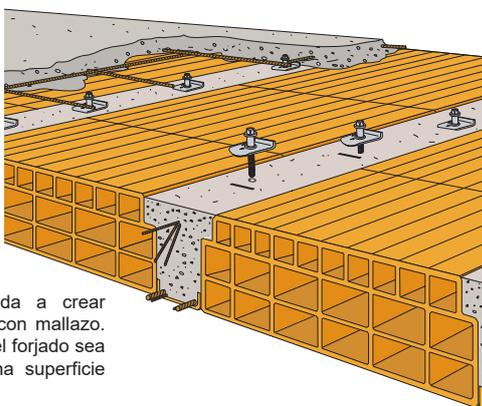
Intervención destinada a crear losa de distribución con mallazo. Necesaria para que el forjado sea habitable y crear una superficie rígida.
