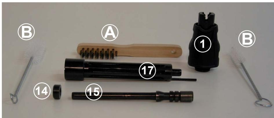
Nettoyer l'extérieur du canon (n°17 - canon) avec la brosse métallique (A). Ensuite passer dans les guides et les crans, ainsi que dans la partie interne du canon et du guide tampon (n°1 – guide tampon monocoup) à l'aide des brosses de plastique (B) et (C).
