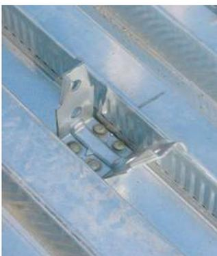
El conector DIAPASON es de chapa cincada de 3 mm de espesor, moldeada para obtener una base fijada con **cuatro clavos** en la viga de acero y dos alas superiores para que la conexión con el hormigón sea más eficaz. Este conector se caracteriza por sus elevadas prestaciones mecánicas.
