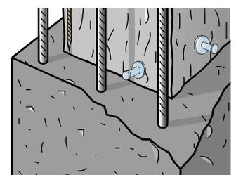
Le barre verticali andranno inghisate alle fondazioni con le resine bicomponenti Tecnar, in appositi fori creati al piede del pilastro.
